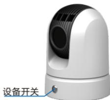
**【说明】开关/指示灯：**长按3秒开机，开机后设备开关灯常亮；连接电源充电，充电时设备开关灯2.5秒亮，2.5秒灭；电量充满，指示灯常亮；电量不足，指示灯快闪，200毫秒亮，200毫秒灭。**待机时长：**开启红外灯，待机时长约3.5小时；不开启红外灯，待机时长约7.5小时。
